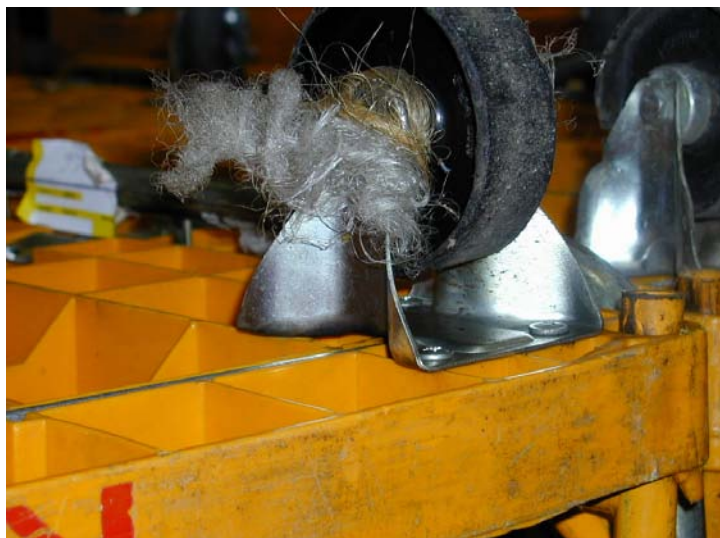
schwergängige Rollen wegen aufgewickelter Schnüre und Fäden
