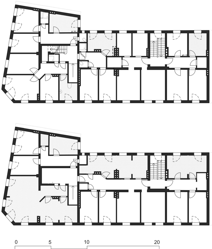
Abb. 2: Grundriss des Wohnprojekts GoMokry vor dem Umbau (oben), nach dem Umbau (unten), Gemeinschaftsflächen in grau, eigene zeichnerische Darstellung.
