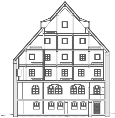
Höhenstaffelung unterschiedlicher Raumtypologien. Planzeichnung: Miller & Maranta Architekten
