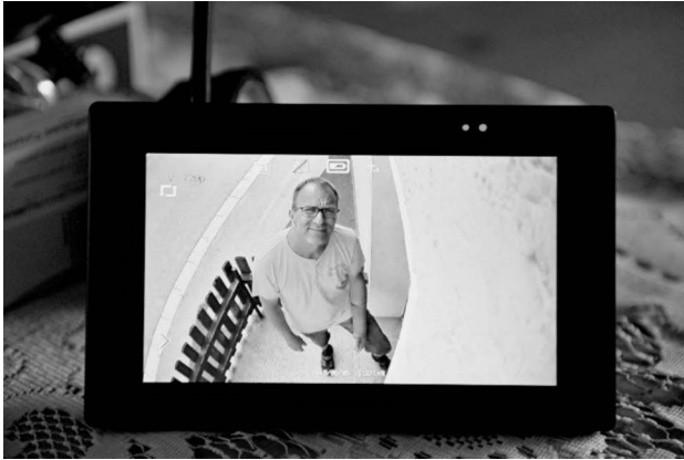
Abbildung 6: Mobiles Tablet und Videokamera integriert mit Türöffnung
