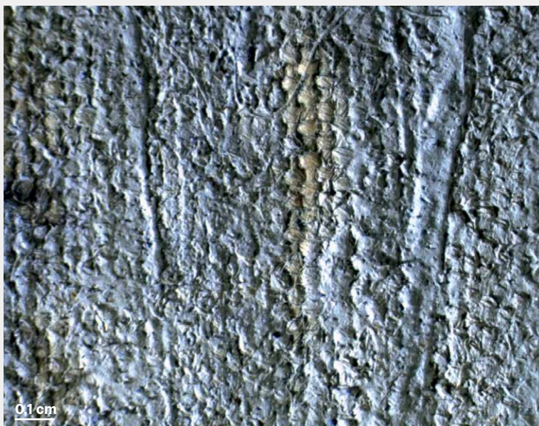
Abb. 2.9 Detail malerische Ausführung (Stereomikroskop). In den hell ausgemischten Farbflächen verwendete Klee eine fliessfähige Farbe.
