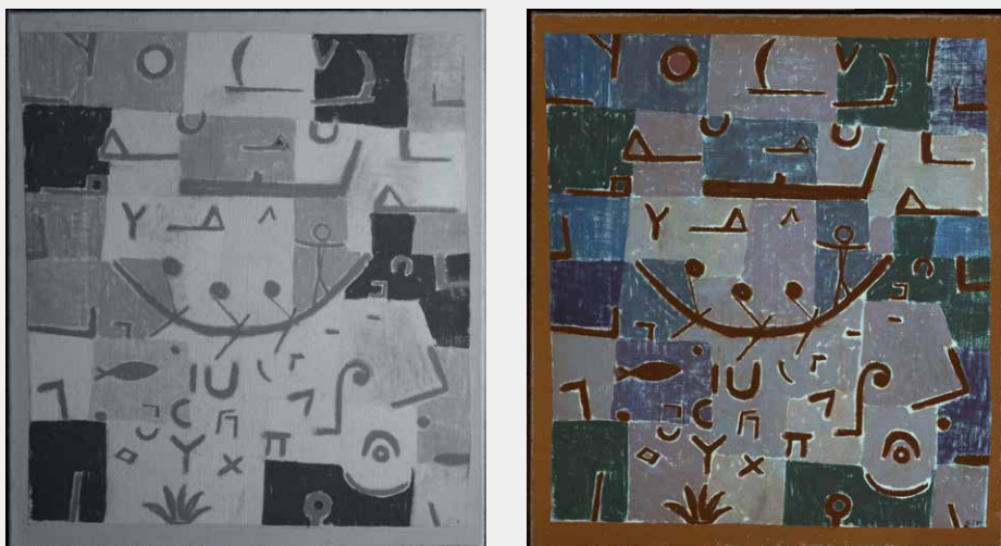
Abb. 2.6 Gesamtaufnahme IR-Reflektografie und UV-Fluoreszenz. Die IR-Reflektografie zeigt (links), dass in den hellen Farbfeldern Schichtdickenunterschiede aufgrund des Pinselduktus vorliegen. Die UV-Fluoreszenz-Aufnahme (rechts) kontrastiert zudem verschiedene Bindemittel, die auf eine Fixierung hinweisen.
