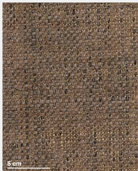
Abb. 1.3 Detail textiler Bildträger. Die unregelmässige Fadenstärke, die dunkle Beschichtung der senkrecht verlaufenden Fäden und das partielle Durchdringen der Grundierung sind gut erkennbar.
