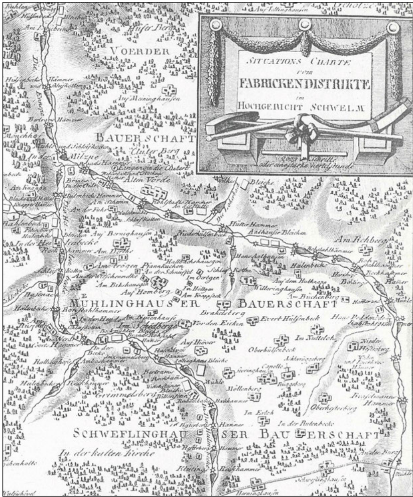
Abb. 1: Kartenausschnitt mit Hammerwerken entlang der Ennepe. Sie sind an den sternförmigen Symbolen zu erkennen, denen – gekennzeichnet durch die ausgefüllten Flächen – jeweils Stauteiche vorgelagert sind.
