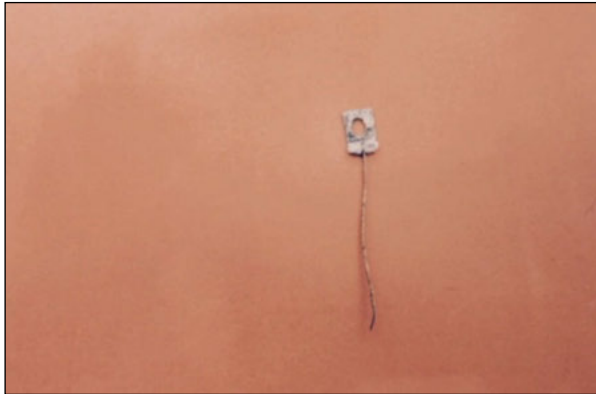
Abb. 3b: Reparierte Feder für den Hammer des Schlagwerks.
