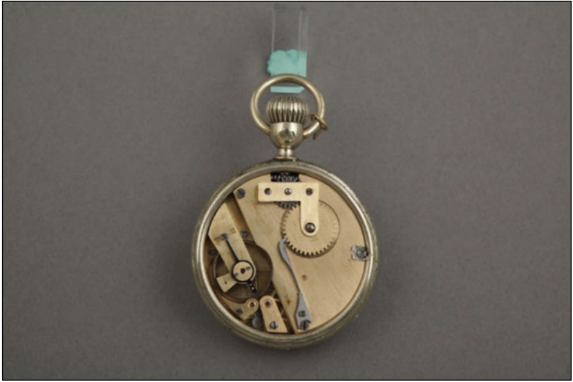
Abb. 5a: Roskopf-Bewegung mit Klinke aus einem Stück.
