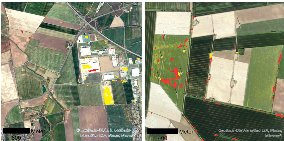
Abb. 4: Anwendung der Filter: gelb bleibt, rot wird gefiltert, (l.) Teil einer Siedlungsfläche mit neuen Industriehallen > 300 m 2 , (r.) Windkraftanlagen werden in die Postprozessierung mit einbezogen (Quelle: eigene Abbildung)
