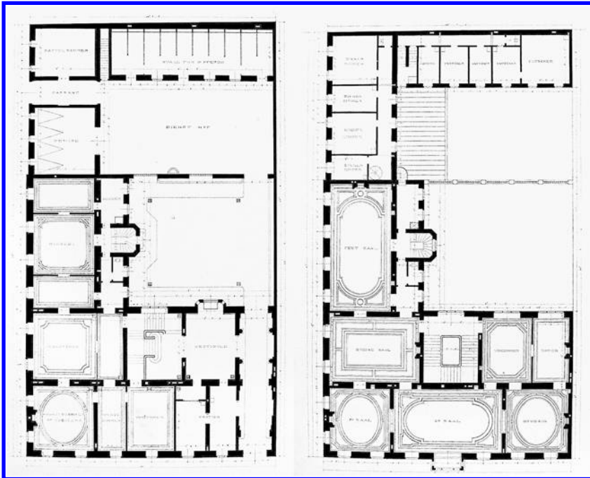
Abbildung 77: Erdgeschoss und Hauptgeschoss der Botschaft: im oberen Teil jeweils das Dienerschaftsgebäude mit Ställen für 10 Pferde und Remise, darüber Kutscher- und Dienerzimmer; durch eine Mauer abgetrennt der Hof der Botschaft, in der Durchfahrt der Eingang ins Vestibül, von dem aus es über das Treppenhaus ins Hochparterre der Kanzlei geht, bestehend aus Vorzimmer, Wartezimmer, Arbeitszimmer des Botschafters, Bibliothek und drei Kanzleiräumen; im Hauptgeschoss vier kleinere Empfangsräume, ein großer Salon, ein Speise- und ein Festsaal. Abbildung aus: NAK MPD 1/123 – Maps and plans extracted from records of the Treasury.
