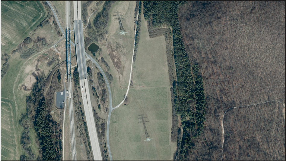
Abb. 5. Bündelung der Neubaustrecke Erfurt – Nürnberg der Deutschen Bahn (links) mit dem Neubau der Autobahn A71 Erfurt-Suhl (Mitte) sowie einer Hochspannungsleitung bei Arnstadt (rechts) (Quelle: DOP20, © GDI-Th)
