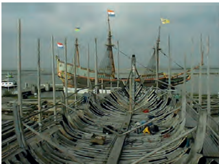
Abb. 10–12 Der volkstümliche Bootsbau wie auch die Nachbauten historischer Fahrzeuge liefern uns wichtige Hinweise für die Verwendung der Schalenbauweise und den Übergang zum Skelettbau. Oben: Dorleijns Studien über den holländischen Richtspantenbau bei kleineren Fahrzeugen, den sogenannten Butterschiffen. Unten links: Die auf der Bataviawerft entstehende ZEVEN PROVINCIE wurde in den 1990er Jahren zuerst in Schalenbau unter Verwendung nur von Knappen gefertigt. Dieser Versuch wurde abgebrochen und das Schiff nun in Skelettbauweise gefertigt. Unten rechts: Die GÖTEBORG, der Nachbau des gleichnamigen schwedischen Ostindienfahrers, ist ein Beispiel für das Studium des frühen, reinen Skelettbaus.
