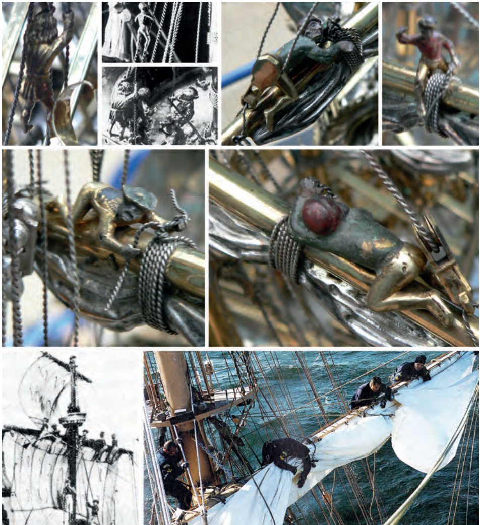
Abb. 37–45 Die Darstellungen auf dem Schlüsselfelder Modell (Fotos oben und Mitte) sinnbildlichen anschaulich das halbsbrecherische Arbeitsleben im Rigg zu Beginn des 16. Jahrhunderts. Einen wesentlichen Fortschritt bedeutete die Einführung von Fußpardunen zu Beginn des 17. Jahrhunderts, wie wir sie als frühes Zeugnis beim Peller-Modell von 1603 aus dem Germanischen Nationalmuseum in Nürnberg und im Prinzip unverändert noch heute auf Segelschulsschiffen eingesetzt sehen (Fotos unten). (Fotos: Verf.)
