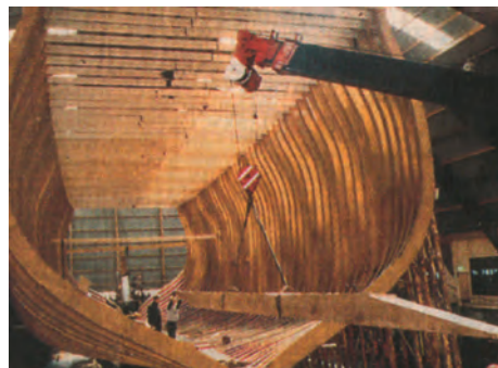
Abb. 10–12 Der volkstümliche Bootsbau wie auch die Nachbauten historischer Fahrzeuge liefern uns wichtige Hinweise für die Verwendung der Schalenbauweise und den Übergang zum Skelettbau. Oben: Dorleijns Studien über den holländischen Richtspantenbau bei kleineren Fahrzeugen, den sogenannten Butterschiffen. Unten links: Die auf der Bataviawerft entstehende ZEVEN PROVINCIE wurde in den 1990er Jahren zuerst in Schalenbau unter Verwendung nur von Knappen gefertigt. Dieser Versuch wurde abgebrochen und das Schiff nun in Skelettbauweise gefertigt. Unten rechts: Die GÖTEBORG, der Nachbau des gleichnamigen schwedischen Ostindienfahrers, ist ein Beispiel für das Studium des frühen, reinen Skelettbaus.
