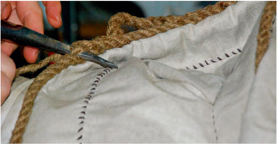
Abb. 17 Um saubere Handarbeit sichtbar zu machen, können dunkle Garne auf hellem Tuch verwendet werden. (Foto: Inger Smedsrud, Norsk Håndverksinstitutt/Norsk Handverksutvikling)
