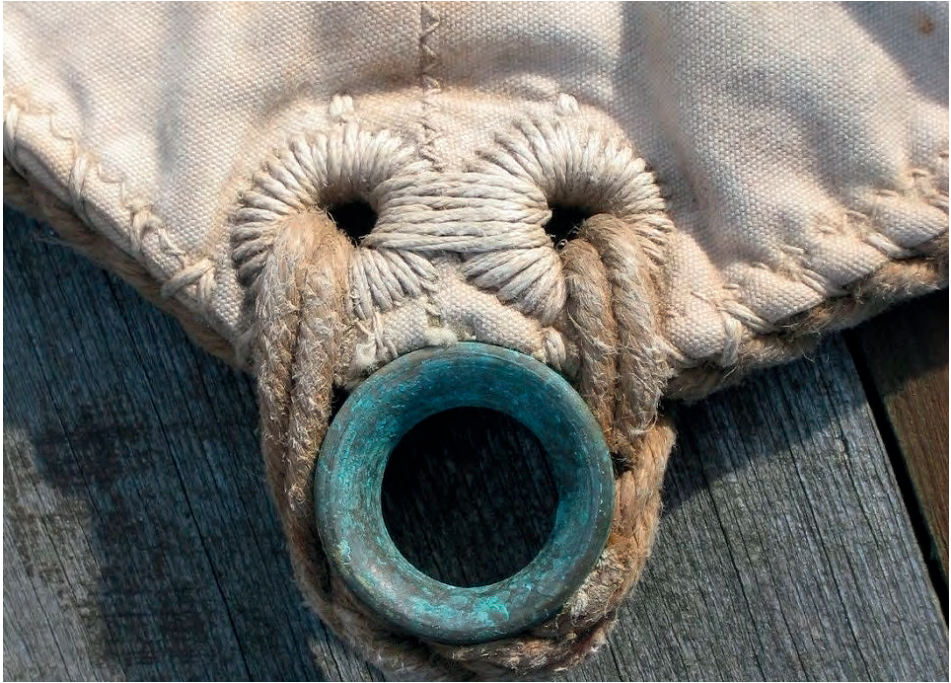
Abb. 32 Ein in einer Schotecke aufgesetzter Lögel mit einer Rundkausch. Der Lögel wird aus einem Kardeel gespleißt, welches durch Gattchen geführt wird. Der Lögel gilt dann als fachgerecht ausgeführt, wenn sich die Kausch nicht im Lögel drehen lässt. (Foto: Verf.)
