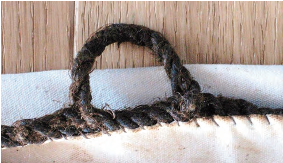
Abb. 35 Ein einfacher Taulögel ohne Kausch, wie er auf den Lieken der VASA-Segeln zu finden ist. Ein einzelnes Kardeel wird in sich selbst gelegt und die Enden in das Liek verspleißt. (Foto: Verf.)
