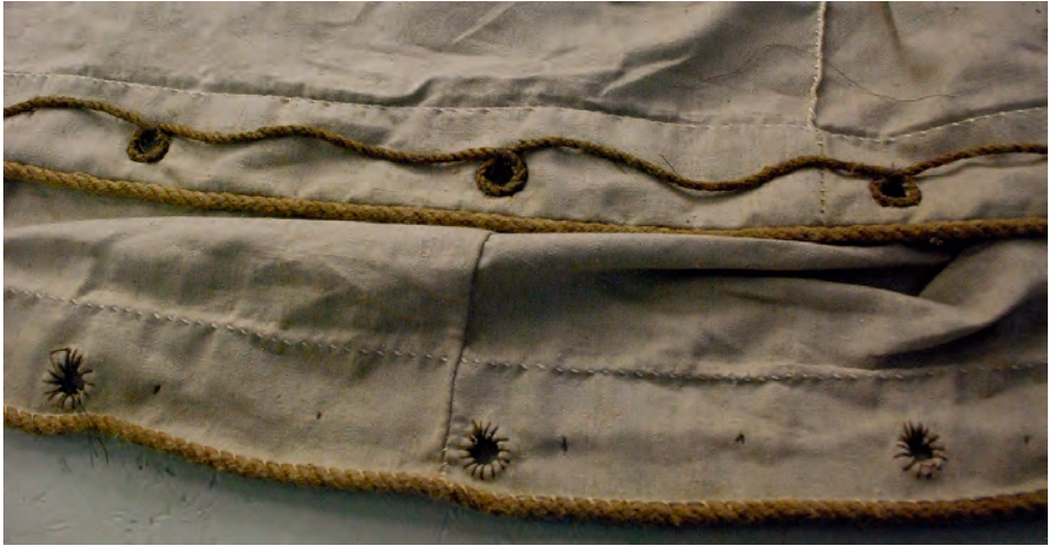
Abb. 29 Gattchen, wie sie an den Segeln der VASA und der MARY ROSE ausgeführt wurden. Aus einer dünnen, langen Leine wurden in den notwendigen Abständen Augen gelegt, die mit wenigen, groben Stichen im Tuch befestigt wurden. Die lange Leine wurde jeweils zwischen den Gattchen mit wenigen Stichen festgesetzt, hier rekonstruiert an einem kleineren Rahsegel. (Foto: Inger Smedsrud, Norsk Håndverksinstitutt/ Norsk Handverksutvikling)
