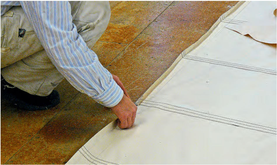
Abb. 19 Die Kantsäume werden eingestrichen, d.h., dass das Tuch mit dem Rücken der Schere (in diesem Bild von der rechten Hand verborgen) einen kräftigen, dauerhaften Kniff erhält, der das Vernähen vereinfacht. (Foto: Inger Smedsrud, Norsk Håndverksinstitutt/Norsk Handverksutvikling)
