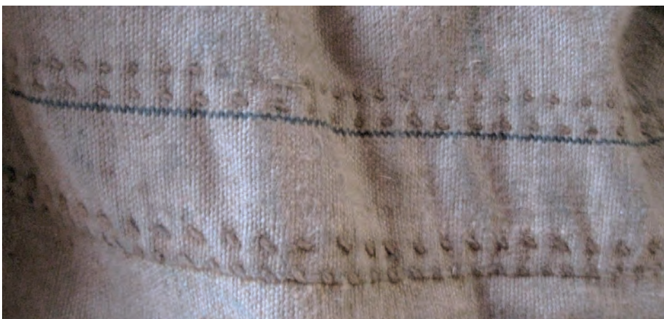
Abb. 16 Eng gesetzte Stiche aus kräftigem Handgarn, gut erkennbar auch der blaue Kennfaden, der zur Markierung der Nahtbreite ins Segel gewoben wurde. (Foto: Verf.)
