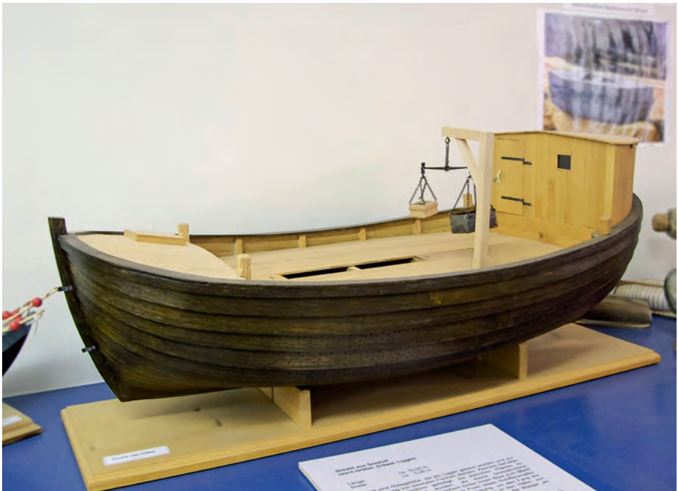
Abb. 5 Modell eines Drewels im Maßstab 1 : 15. (Modell und Foto: Helmut Olszak)
