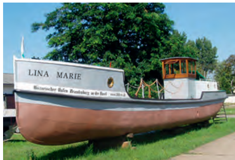
Abb. 29–30 Havelquatze LINA MARIE in Brandenburg/Havel: Baujahr 1901 für Schröder, Brandenburg, Baunr. 20 der Werft Gebrüder Wiemann, Länge 18,8 m, Breite 2 m, Höhe 1,35 m. Links in Fahrt am 18. November 2006, rechts aufgestellt an Land am 6. August 2007. (Fotos: Conrad Helmcke/Historischer Hafen Brandenburg e.V.)
