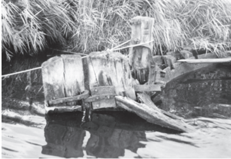
Abb. 53–56 Das Wrack der SCHOLLE. Erkennbar sind das Vorschiff (rechts oben) sowie Achter- (links unten) und Vorsteven (rechts unten). (Fotos: Michael Sohn, 1988)
