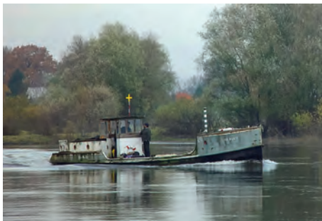
Abb. 29–30 Havelquatze LINA MARIE in Brandenburg/Havel: Baujahr 1901 für Schröder, Brandenburg, Baunr. 20 der Werft Gebrüder Wiemann, Länge 18,8 m, Breite 2 m, Höhe 1,35 m. Links in Fahrt am 18. November 2006, rechts aufgestellt an Land am 6. August 2007. (Fotos: Conrad Helmcke/Historischer Hafen Brandenburg e.V.)
