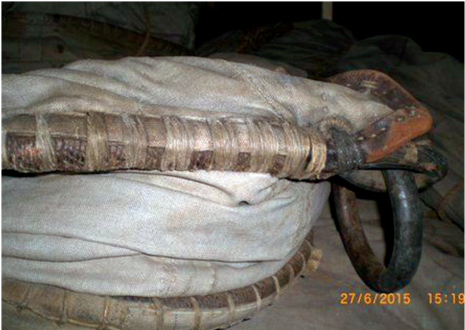
Abb. 48 Detail des Lieks am Rahsegel auf der PASSAT. (Foto: Peter Kraus, Hamburg)
