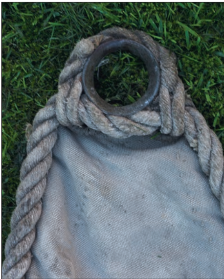
Abb. 63–65 Details der Fock (Reserve) der JANTJE. Saum und Vorliek (oben links); Gattchen mit Stagreiter (oben rechts); Kausch am Kopf (links). (Fotos: Verf.)
