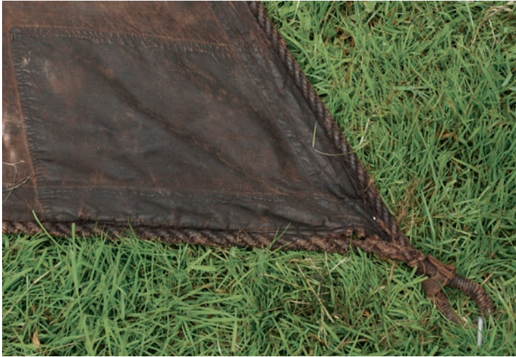
Abb. 51 Einfaches, gebändseltes Auge (Lägel) für die Schot am Sprietsegel eins Schleikahns. (Foto: Verf.)
