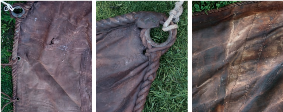
Abb. 66–68 Details des Gaffelgroß der JANTJE. Von links nach rechts: Vorliek und Hals; Schotkautschen; verbreiterte Naht am Fuß. (Fotos: Verf.)
