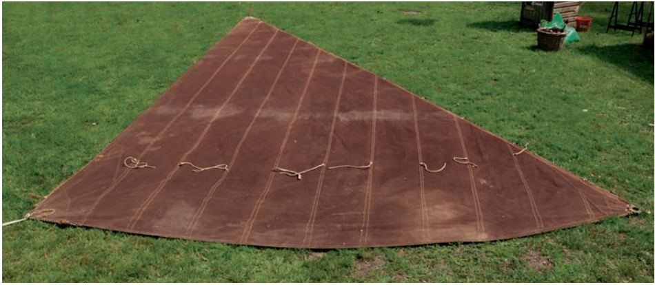
Abb. 58 Große Fock der JANTJE, fertig zum Aufmessen. (Foto: Verf.)
