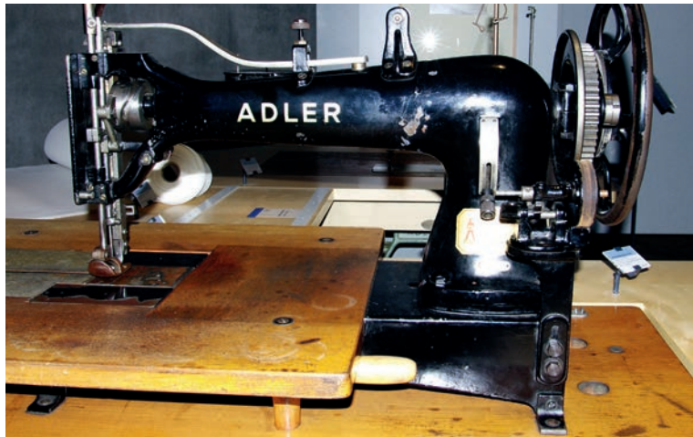
Abb. 41 Schwere Segelmacher-Nähmaschine, Fabrikat ADLER, Klasse 20, im Deutschen Technikmuseum Berlin. (Foto: Verf.)
