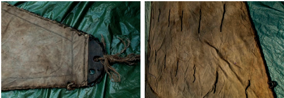
Abb. 59–60 Fock des Zeesbootes FISCHER HERBERT AHR 6: Kopfbrettchen und Reffreihen. (Fotos: Verf.)
