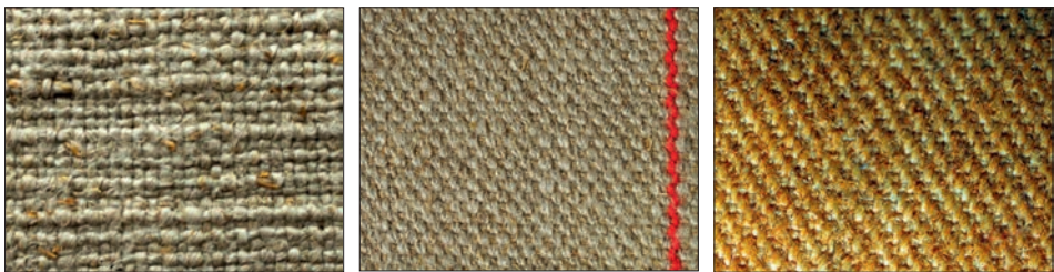
Abb. 22–24 Leinwandbindung (links), Segeltuchbindung (Mitte) und Köperbindung (rechts). (Fotos: Verf.)
