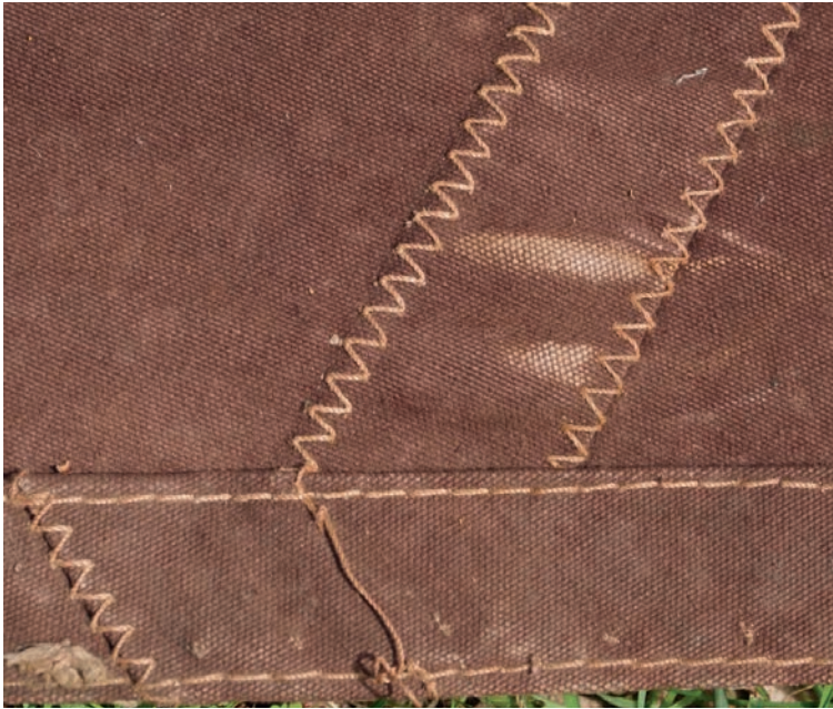
Abb. 43 Zickzack-Nähte, große Fock der JANTJE. (Foto: Verf.)
