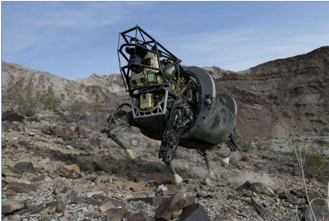
Abbildung 26: „AlphaDog LS3“: 1,70m hoch, 590kg schwer 1546
