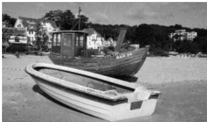
Abb. 6 Das hölzerne Strandboot BAN 24 und ein neuerdings ebenfalls in der Strandfischerei verwendetes GFK-Boot, BAN 27, mit (am Strand abgebautem) Außenbordmotor in Bansin/Usedom, 1999.
