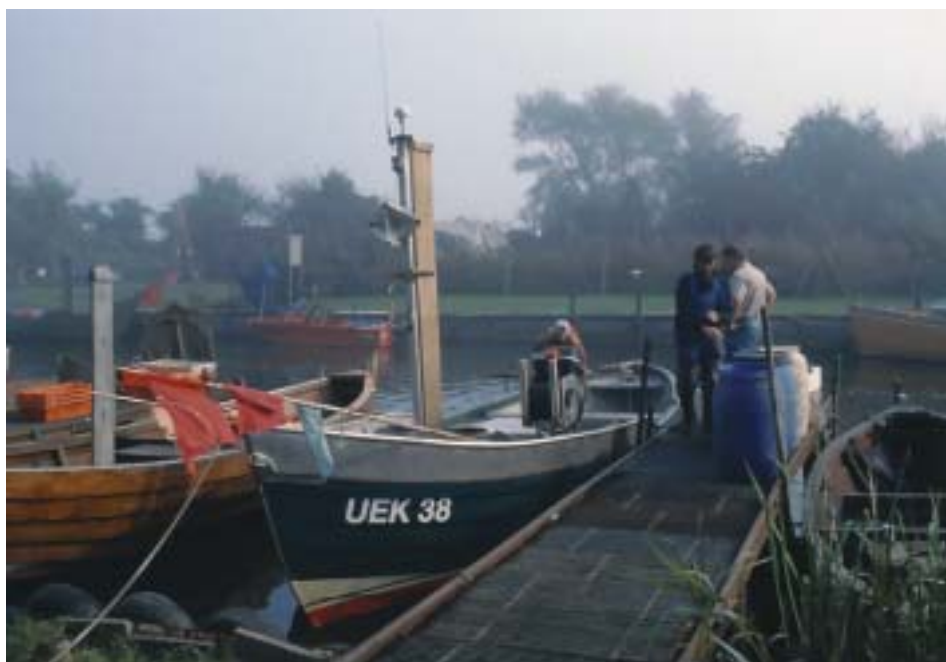
Abb. 1 Neben Heuern aus Holz und Stahl sind seit etwa 1986 auch einige in Plau am See erbaute Boote dieses traditionellen Typs aus glasfaserverstärktem Kunststoff (GFK) auf dem Stettiner Haff anzutreffen, hier GFK-Heuer UEK 38 von Hartmut Dieckmann aus Ueckermünde – nachgerüstet mit Netzholer, GPS und Sprechfunk-Einrichtung – am Liegeplatz im Neuendorfer Kanal, 1998. (Alle Fotos zu diesem Beitrag: Wolfgang Steusloff)
