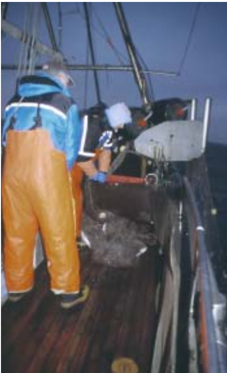
Abb. 16 Beim Einholen von Stellnetzen an Bord des Warnemünder Kutters WAR-6 PREROW, 2006. Eingeholt wird das Netz mit Hilfe eines hydraulischen Netzholers, manövriert wird dabei am zweiten, an Deck befindlichen Fahrstand.
