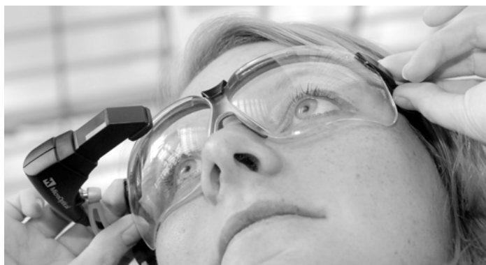
Abb. 8: Head-Mounted Display an einer Schutzbrille (Bild: MRC)
