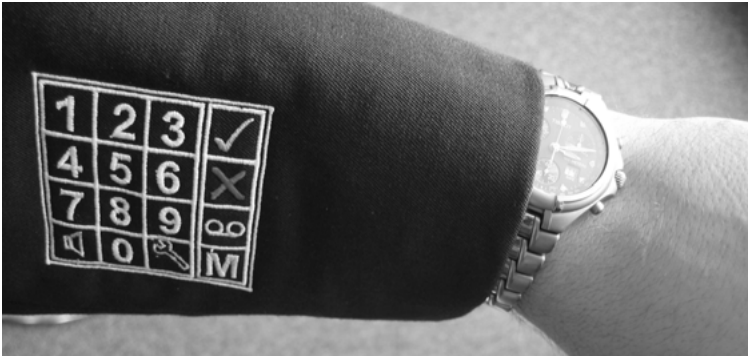
Abb. 5: Integration einer Tastatur in die Bekleidung (Bild: MRC)
