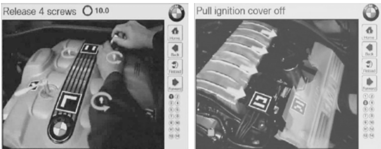
Abb. 4: Beispiele einer Augmented-Reality basierten Reparaturanleitung (© BMW AG).
