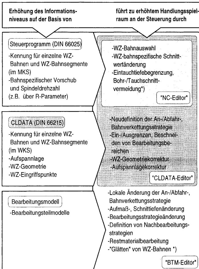
Abb. 2.3: Zusammenhang zwischen erhöhtem Informationsniveau der Schnittstellenvarianten und den somit realisierbaren Modifikationsfunktionen
