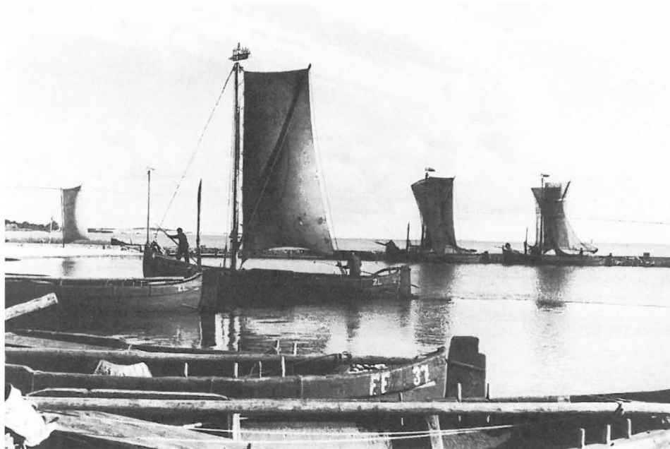
Keitel- oder Kurrenkahn mit der Bezeichnung NID 36 ZL. Der Name des Fischers steht nicht im Segel. Die Versalien ZL und FF weisen die Kähne als Fischereifahrzeuge aus. Beispiel für den Kurrenkahn mit Sprietsegel. (Archivfoto DSM)
