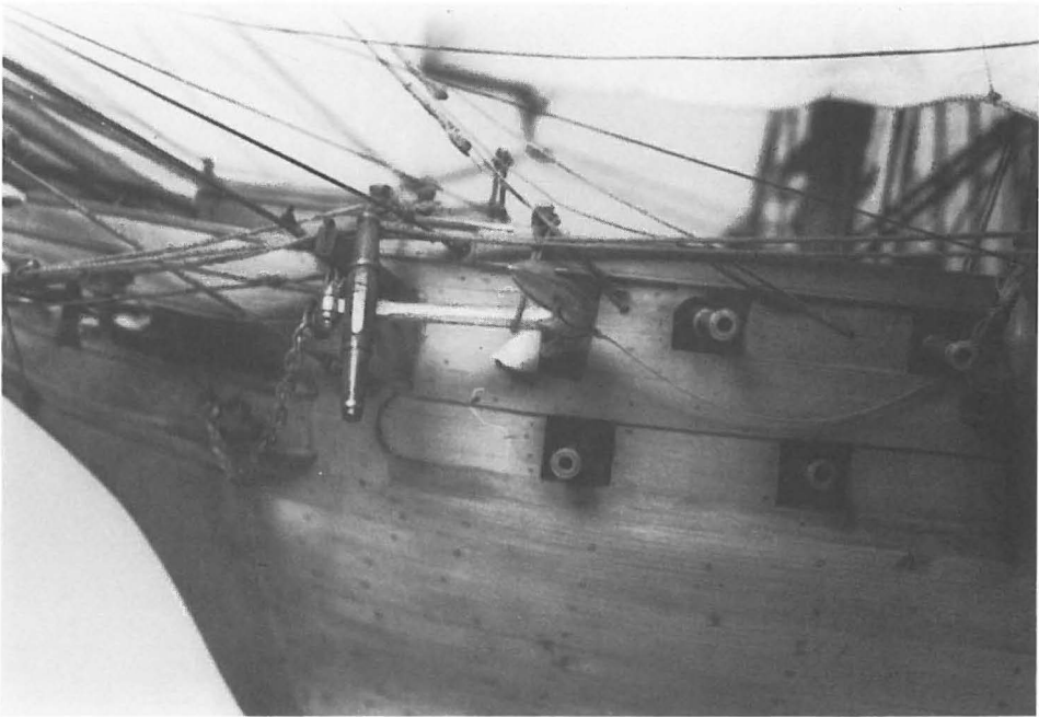
Abb. 26 Unbekannte Fregatte: der Bordanker mit Ankerboje (am rechten Bildrand).
