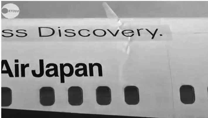
Pilotenfehler: Beschädigter Rumpf eines Passagierflugzeugs nach einer harten Landung. 426
