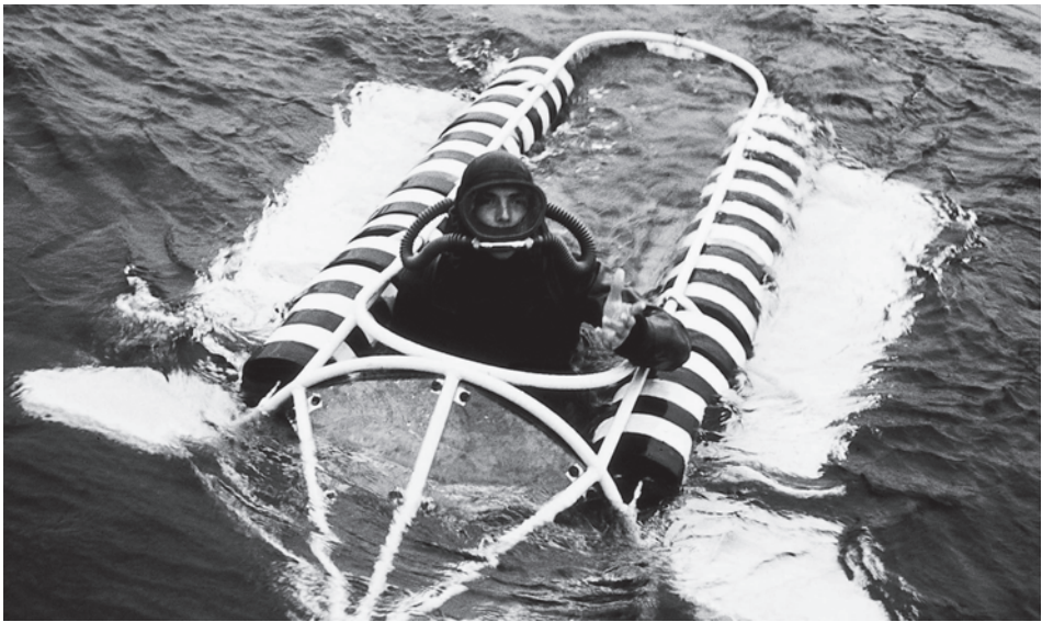
Abb. 14 Der Zwei-Mann-Taucherschlitten des Instituts mit beweglichen Scherflossen, wie er auch 1959 im Roten Meer im Einsatz war. (Foto: Verf.)
