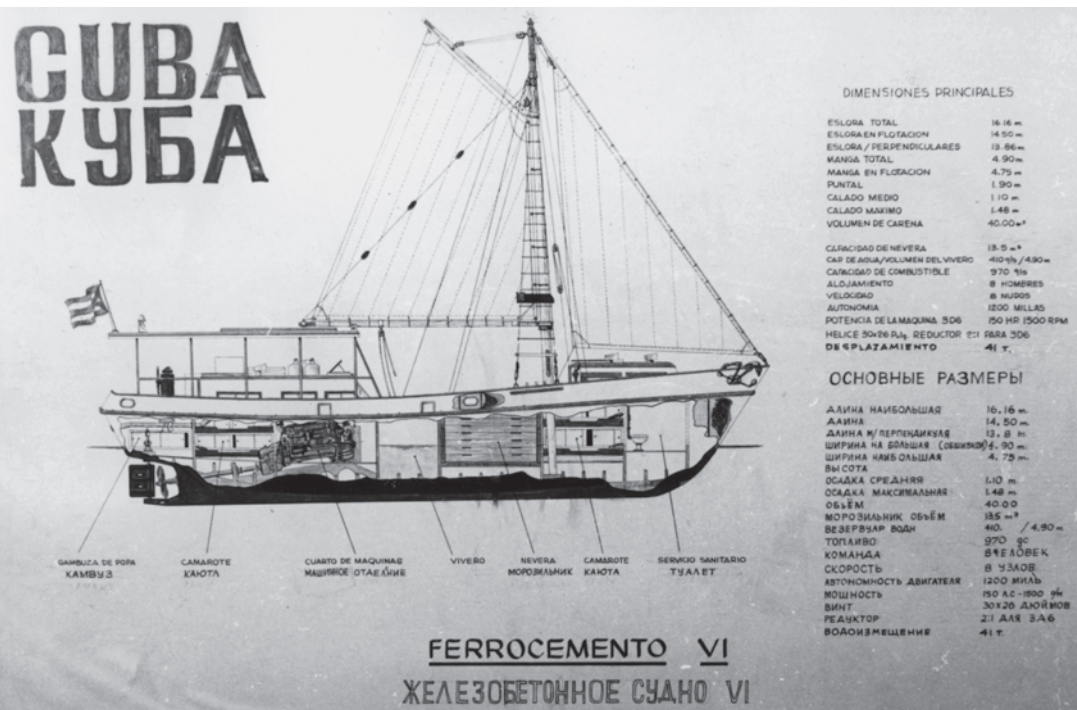
Abb. 43 Prinzipdarstellung eines 41-t-Stahlbeton-Fischkutters mit Hilfsbesegelung aus kubanischer Produktion. (Archiv Schiffbau- und Schifffahrtsmuseum Rostock)
