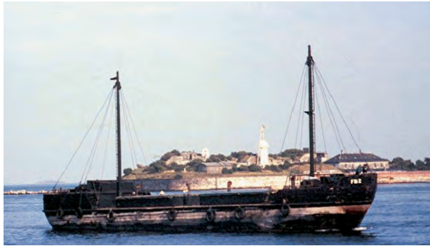
Abb. 33 Sechs Betonschiffe vom Typ »Seeleichter Wiking« wurden 1951 von der dänischen Bergungsreederei Det Forenede Bugserelskab erworben und als Bergungsleichter eingesetzt. Auf dem Foto das schwarz gestrichene Betonschiff FB 2 in Kopenhagen, 1968. (Foto: Holger Munchaus Petersen, Kopenhagen)
