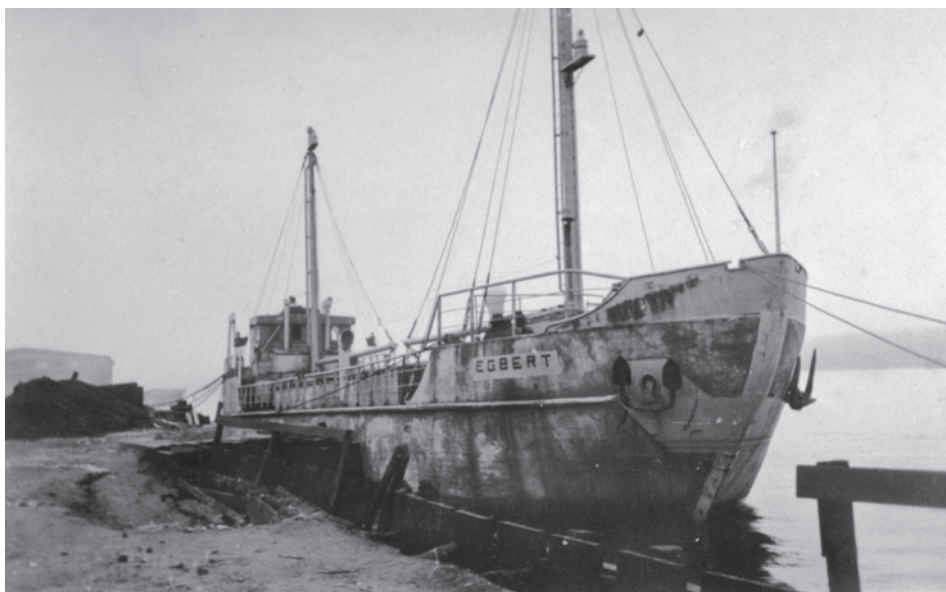
Abb. 32 MS EGBERT war ein 300-t-Beton-Küstenmotorschiff vom Bauplatz Rotterdam-Merwehaven, Aufnahme 1945. (Archiv DSM)
