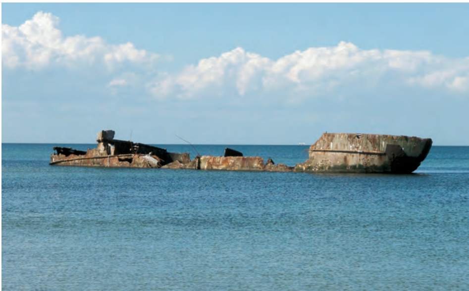
Abb. 34 Nach 60 Jahren sind von dem aus deutscher Produktion stammenden, nach dem Zweiten Weltkrieg in Dänemark unter dem Namen BRØNSODDE in Fahrt gekommenen Betonschiff nur noch Reste übrig. Das Schiff strandete zusammen mit seinem Schlepper im Januar 1948 vor Sjællands Odde. (Foto: Holger Munchaus Petersen, Kopenhagen, 2007)
