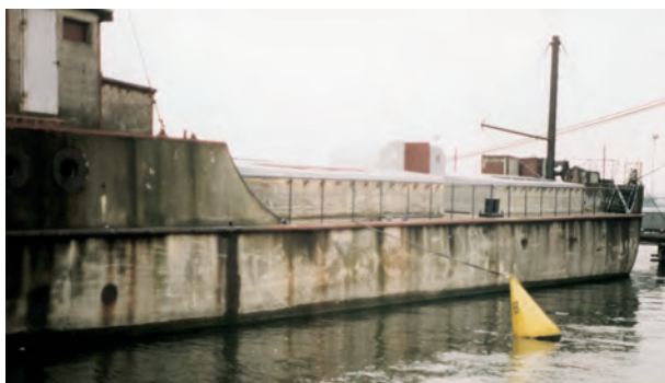
Abb. 39 Das Betonschiff CAPELLA des Rostocker Schiffbaumuseums lag während der Restaurierungsarbeiten 1992–1994 im Rostocker Fischerhafen. (Foto: Archiv Schiffbau- & Schifffahrtsmuseum Rostock)
