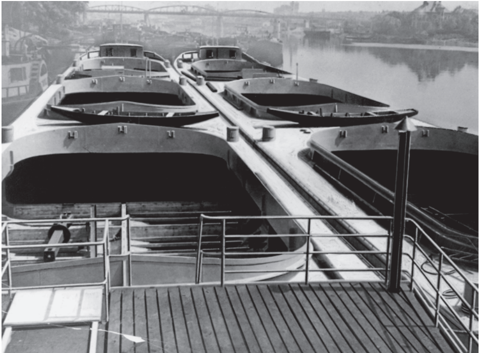
Abb. 31 Decksansicht von Beton-Flussleichtern aus Leichtbeton von der Dyckerhoff & Widmann Werft in Neusatz an der Donau. Die Schiffe verfügten über drei 15 m x 7 m große Lukenöffnungen. (Werksfoto Dyckerhoff & Widmann/Archiv DSM)
