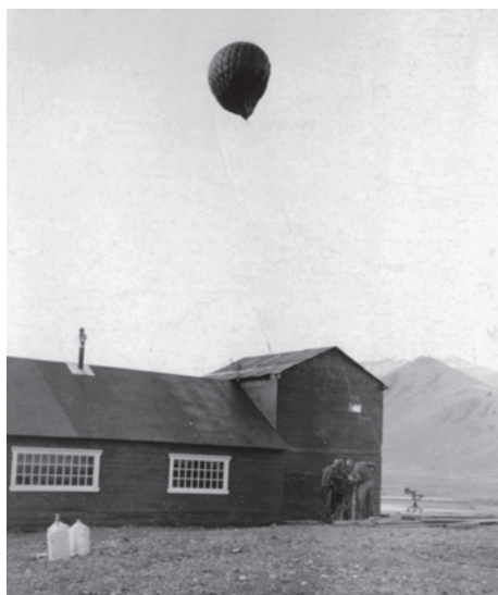
Abb. 14 Fesselballonsondierung zur Gewinnung aerologischer Messdaten.
