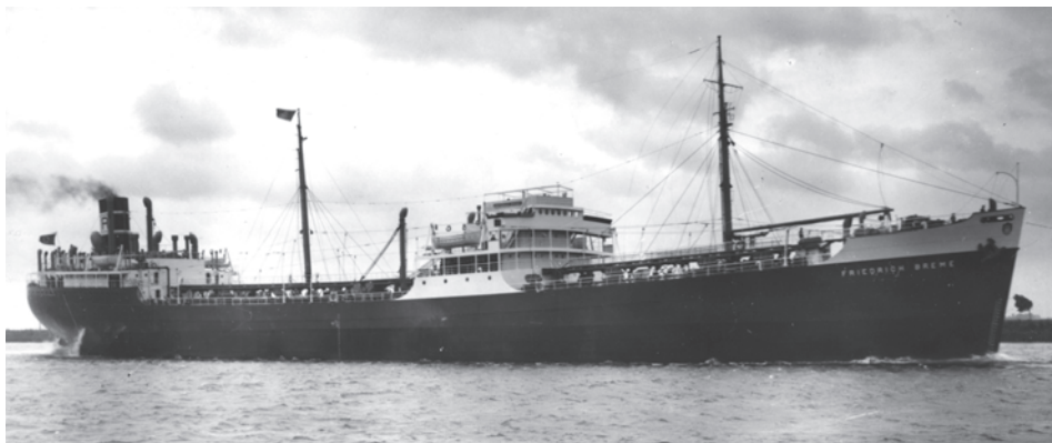
Abb. 1. Motortanker FRIEDRICH BREME. Der Neubau für die Hamburger Deutsch-Amerikanische Petroleum Ges. stellte 1936 den letzten Stand der technischen Entwicklung dar. In seinem Aufbau folgte das Schiff der bewährten Bauweise mit der getrennten Brücke mittschiffs. Der Tanker wurde am 4. Juni 1941 etwa 650 sm westlich der Biskaya von der Besatzung selbst versenkt. (Foto: Historisches Archiv Krupp (HAK)/Archiv DSM)
