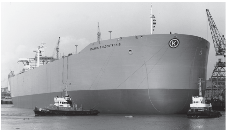
Abb. 9 Stapellauf IOANNIS COLOCOTRONIS. Für den Stapellauf der großen Schiffe wurde der Leitdamm vor dem Werfthafen teilweise entfernt, um einen übermäßigen Wasserstau beim Ablauf zu vermeiden. Dennoch wurden beim Stapellauf der IOANNIS COLOCOTRONIS mehr als 55 000 m 3 Wasser aus dem Hafenbecken verdrängt. Nach dem Abstoppen des riesigen Schiffskörpers übernahmen dann die kleinen Schlepper das Bugsieren des eben getauften Schiffes an die Wertpier. (Foto: Winkler Studios GmbH/Archiv DSM)
