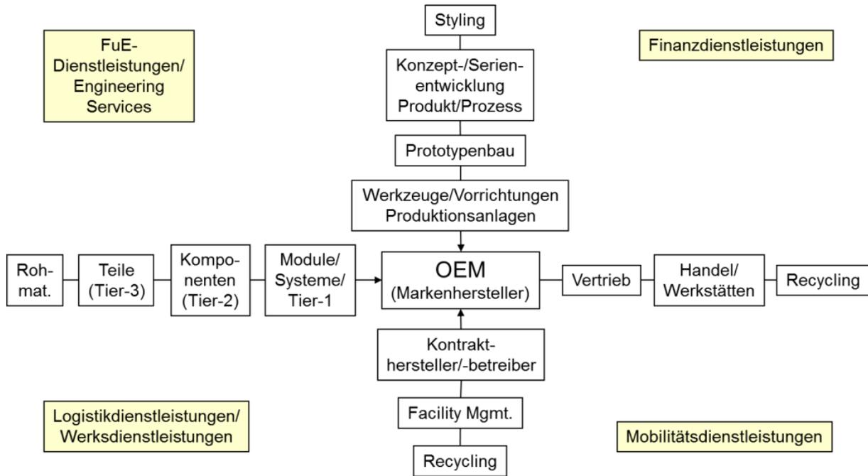
**Abbildung 1: Das System Fahrzeugbau und seine Prozesskette**
