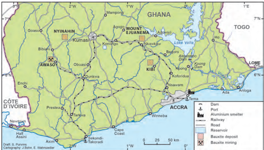
Abb. 1: Infrastruktur der Bauxit-Aluminium-Industrie in Ghana
