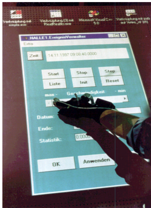
Bild 1: Interaktion mit einem projizierten virtuellen Windows Objekt auf der waagrecht angeordneten Modelltischplatte
