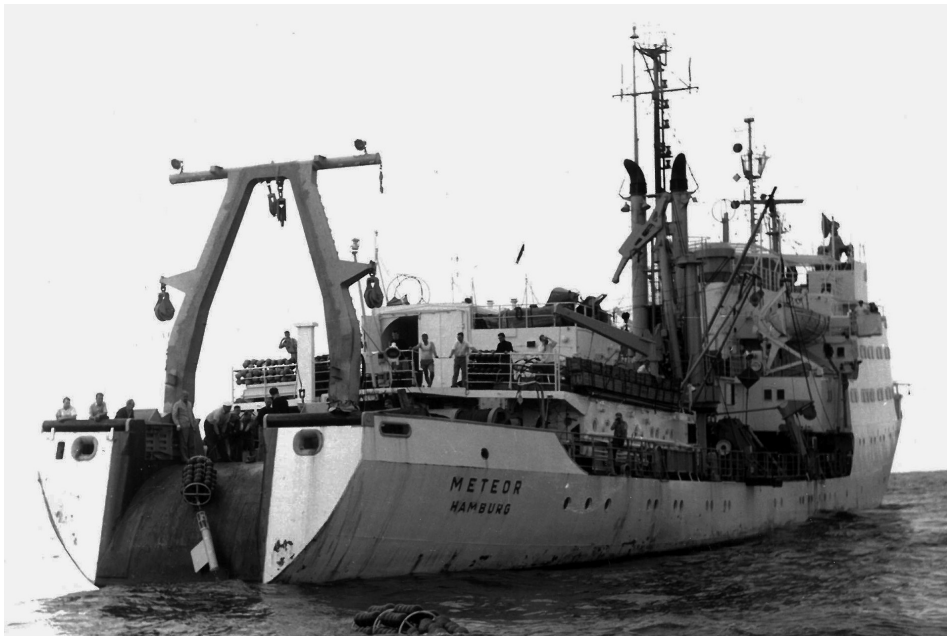
Abb. 8 »Mutterschiff« der westdeutschen Meeresforschung nach dem Zweiten Weltkrieg war die 1964 in Dienst gestellte METEOR (II), hier am Äquator beim Aussetzen einer Strommesserkette. (Foto: Archiv des Verf.)
