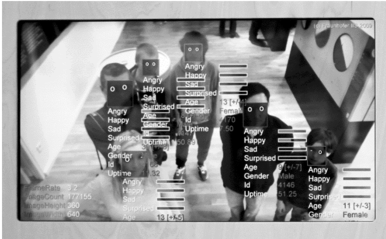
Abbildung 1: Eine smarte Kamera erkennt Alter, Geschlecht und Gemütszustand. (Bild: Steven Lilley, CC BY-SA 2.0)
