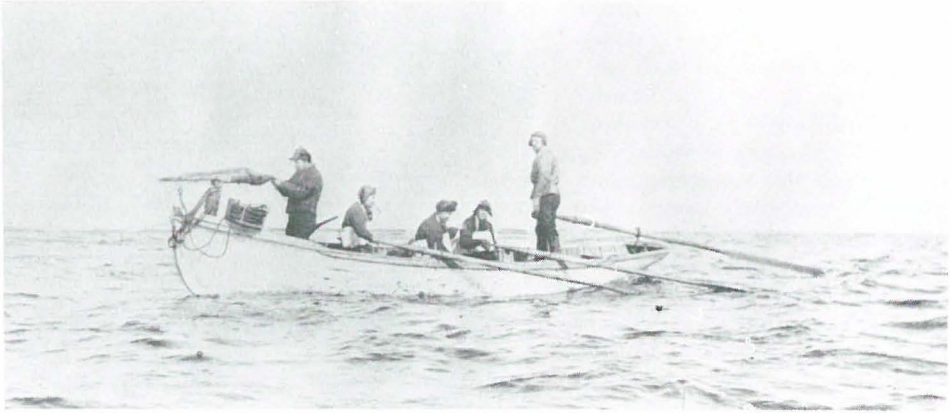
Abb. 5 Fangmethode. Man erwartet das Auftauchen des Wals. Das Döglingsboot scheint ein Plattgatt oder Spiegelbeck zu haben, ebenfalls eine Abweichung vom amerikanischen Bootstyp. (Foto: Christensens Hvalfangstmuseum, Sandefjord)
