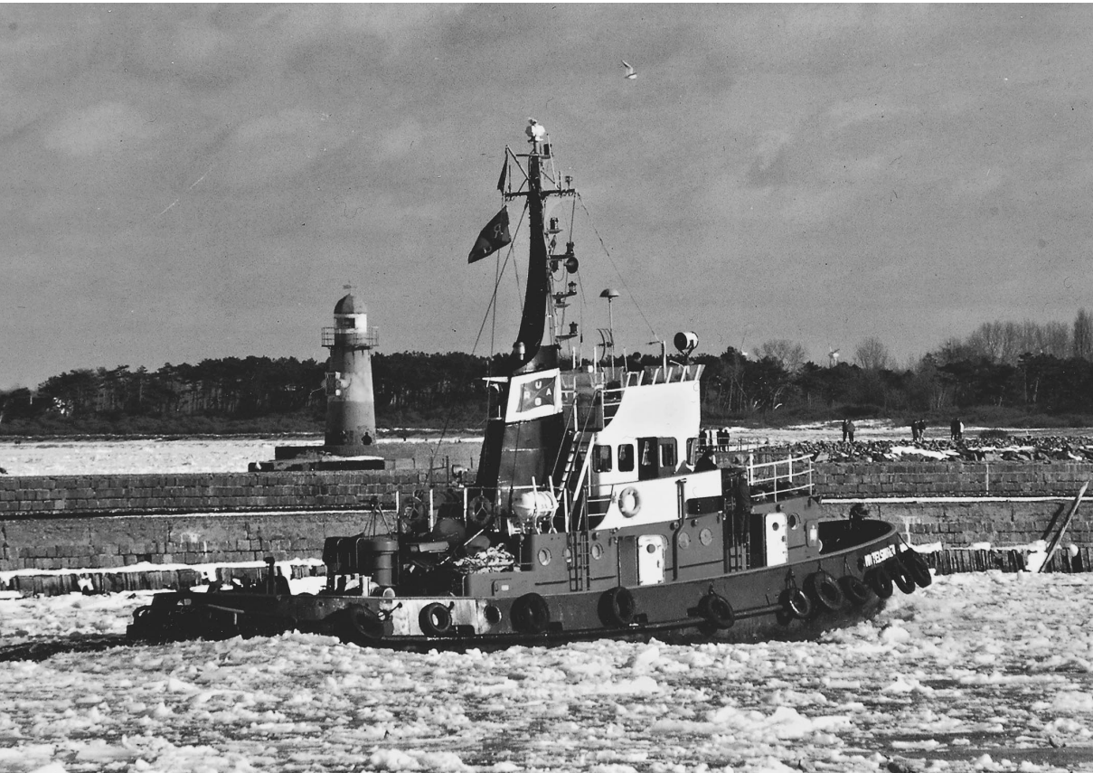
Abb. 16 Der Voith-Schneider-Schlepper MITTELSBÜREN (1700 PS, erbaut 1970 bei der Jadewerft in Wilhelmshaven) in Warnemünde im Neuen Strom am 26. Februar 1996. (Archiv URAG)
