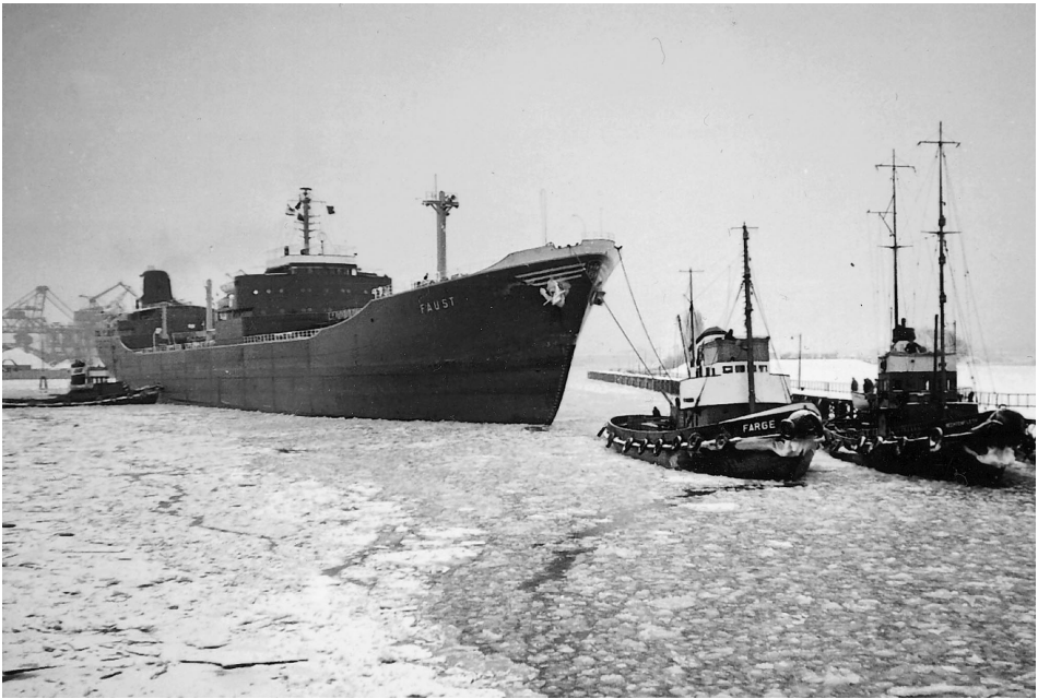
Abb. 7 Assistenz auf der Unterweser für den Motortanker FAUST der Mobil Oil in Hamburg (11 312 BRT, erbaut 1955 beim Bremer Vulkan) am 18. Februar 1956, vorne FARGE (1000 PS, erbaut 1954 bei der Mützelfeldwerft in Cuxhaven) und RECHTENFLETH (950 PS, erbaut 1943 in Groningen für die deutsche Kriegsmarine). (Archiv URAG)
