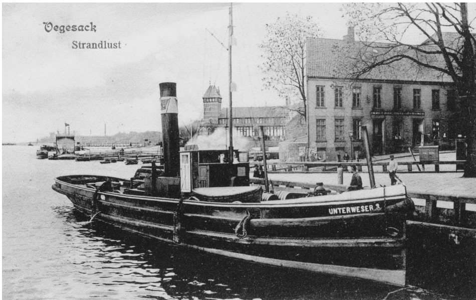
Abb. 2 Zu den von Westphal übernommenen Schleppern der ersten Stunde der SGUW zählte die UNTERWESER 3 (ex BLUMENTHAL, ex ARCHIMEDES, 250 PSI, erbaut 1872 bei Johann Heinrich Arnold Hesse in Brake). Die zeitgenössische Postkarte (Aufnahme A. Sternberg, Hamburg) zeigt das Schiff an der Einfahrt in den Vegesacker Hafen. (Staatsarchiv Bremen)
