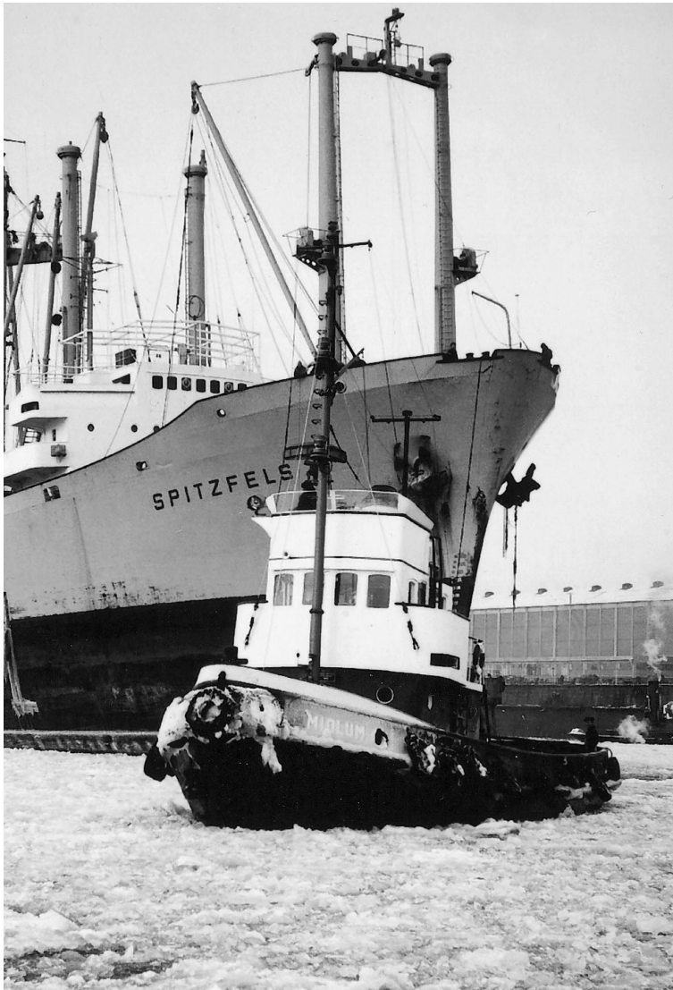
Abb. 8 Motorschlepper MIDLUM (1000 PS, erbaut 1959 bei der Elsfllechter Werft) bei der Assistenz des Frachters SPITZFELS (9336 BRT, erbaut 1957 bei H.C. Stülcken Sohn, Hamburg) der Deutschen Dampfschiffahrtsgesellschaft »Hansa« aus Bremen, vermutlich 1963. (Foto: Hinrich Pundsack, Bremen/Archiv URAG)
