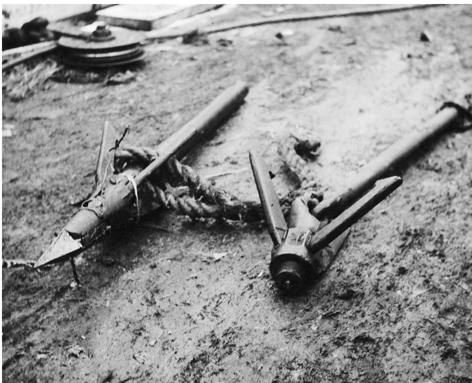
Abb. 5 Adolf Webers elektrische Harpune (links) neben einer konventionellen Explosivharpune (nach Detonation des Sprengkopfs) an Deck des deutschen Walfangmutterschiffs JAN WELLEM, 1937/38. Das DSM besitzt eine solche Weber-Harpune, Kaliber 90 mm.
