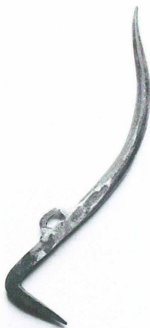
Abb. 18 Biegeeisen, wie es auf dem Schiffbauplatz Firmbach benutzt wurde. (Foto: Verf.)
