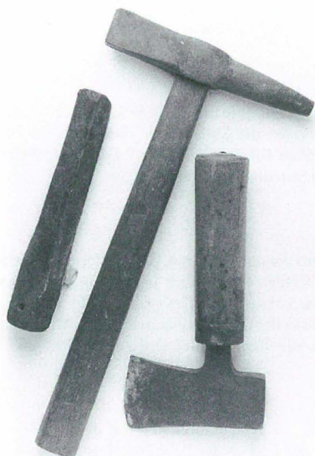
Abb. 17 Werkzeuge zur Anfertigung der Sendelnaht. Rechts: Kemmeisen; Mitte: Zuschlaghammer; links: Biegeeisen. (Foto: Verf.)
