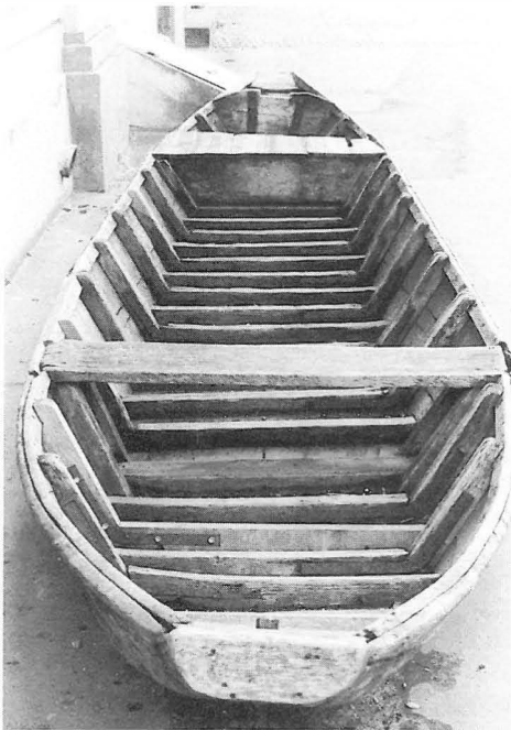
Abb. 5 Dreibord in Wechselspantbauweise. 1953 nach Gustavsburger Muster für einen Fischer aus Güls an der Mosel in Koblenz gebaut. (Foto: Verf.)
