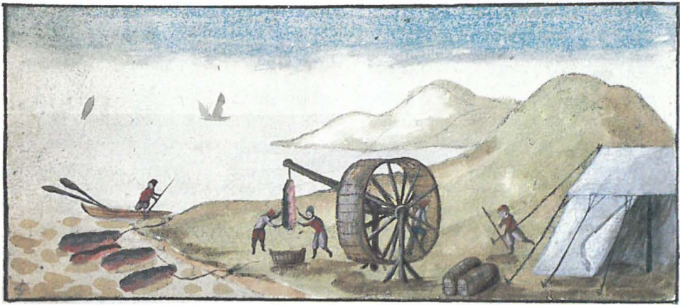
Abb. 14 Der Radkran zum Hieven des Specks. Am Flutsaum die herangeflößten Speckflarden. (Fol. 17v; 7,6 x 17,5 cm).
