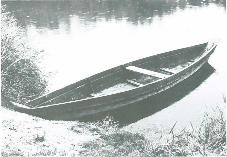
Abb. 9 »Szkutka« mit Metallversteifungen aus Księże Młyny. Diese Variante ist heute die häufigste
