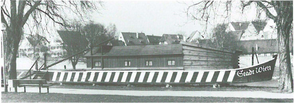
Die STADTWIEN, gebaut von Ulms letztem Schiffbaumeister, Eugen Hailbronner. Deutlich zu erkennen sind der »stehende Stock« und die geringe Hebe.
