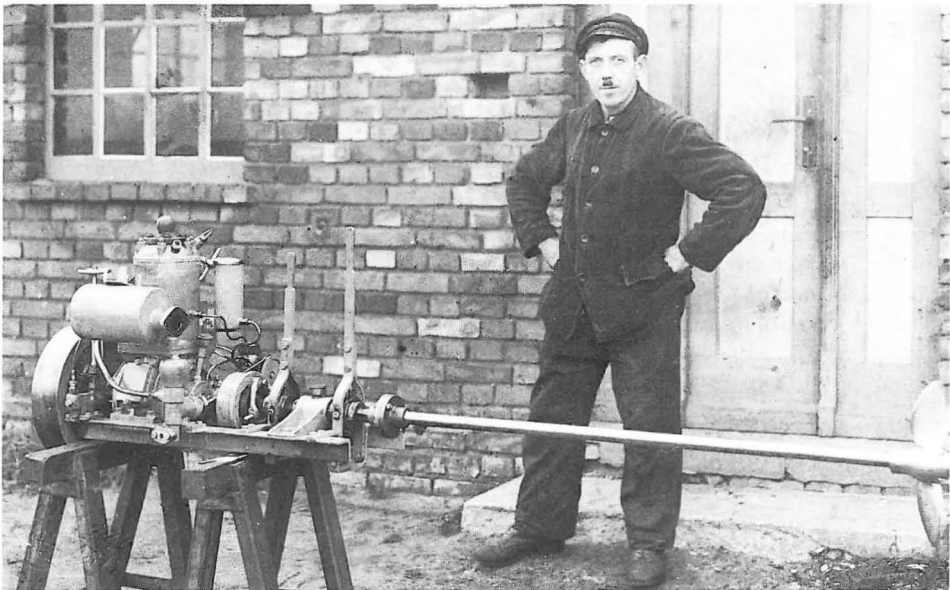
Abb. 32 Arthur Paeschke vor seiner Hafenschmiede in Freest, mit einem neugebauten Glühkopfmotor von 5 PS (1936).
