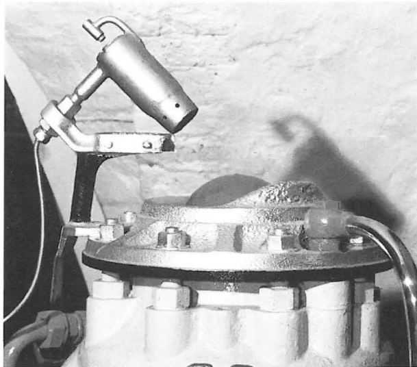
Abb. 12 Glühkopf und Brenner des Schnellerhitzers beim 18-PS-Glühkopfmotor der Deutschen Werke Kiel-Friedrichsort (Elbschifffahrtsmuseum Lauenburg).
