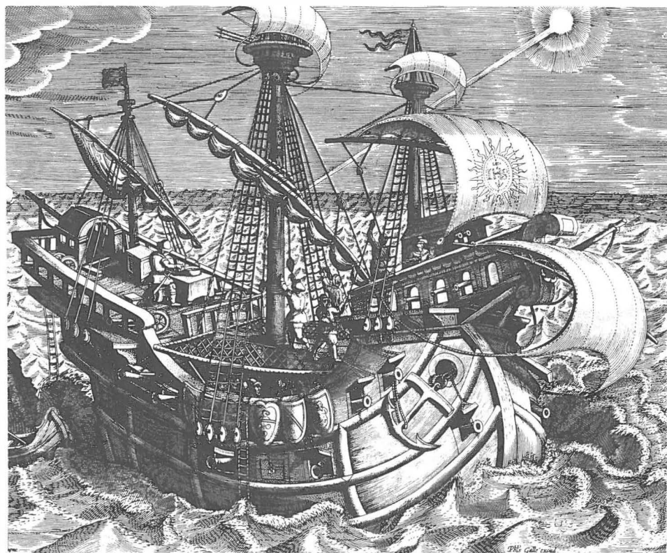
Abb. 3 Kleine Karracke, auf dem Achterkastell mit Kanonen noch auf großrädrigen Land-Lafetten, die unteren Decks bereits mit Stückpforten, um 1600
