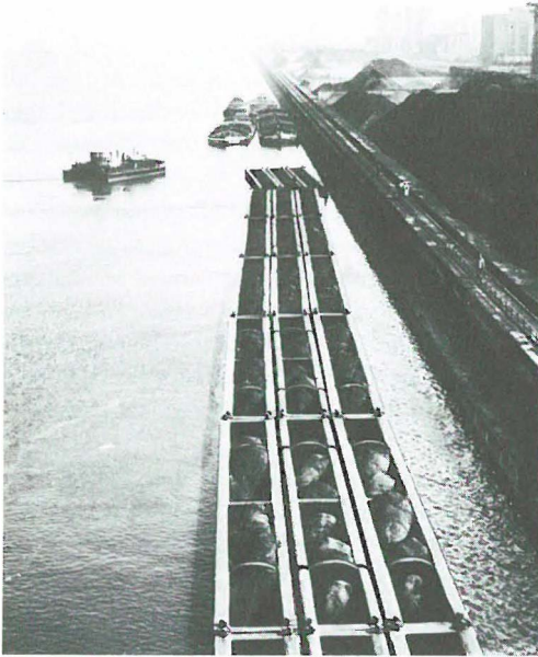
Das Lastrohrfloß konnte je nach den Umständen schnell beliebig verlängert oder verkürzt werden.
