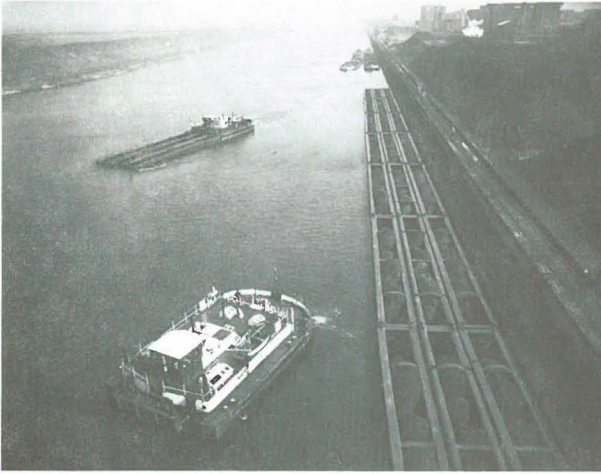
Drei Lastrohre wurden zu einem »Rohrdrilling« nebeneinander und acht solcher Drillinge hintereinander gekuppelt.
