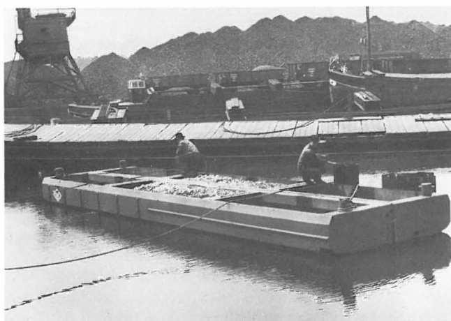
Einfache Kupplungen verbinden die beiden Hälften so, daß sie ein als Wasserfahrzeug verwendbares Lastrohr bilden.
