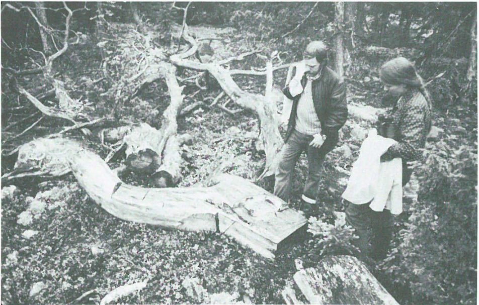
Abb. 14 Immer noch gibt es in den Wäldern an der nördlichen Küste Reste der früher bedeutenden Schiffbautätigkeit. Hier ein zugebautes Spantstück auf Iggön, nördlich von Gävle. (Foto vom Verf., 1978)
