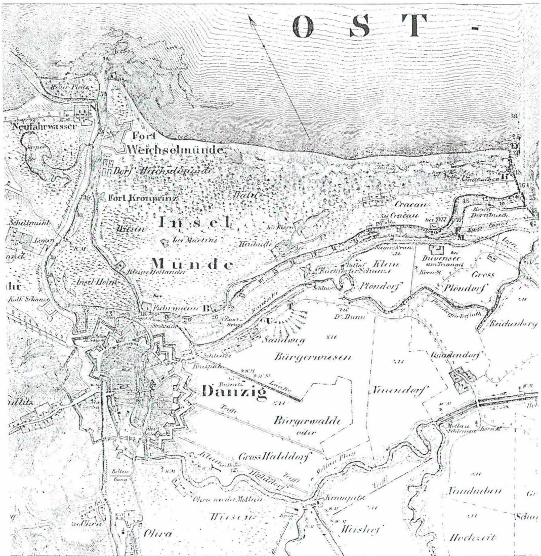
Abb. 2 Der Übersichtsplan des Königlichen Wasser-Bauinspektors Kossak zeigt den Dünen-durchbruch der Weichsel westlich Neufähr sowie die natürliche Gestaltung der neuen Weichsel-mündung. Das Naturereignis machte die bereits fertige Küstenaufnahme dieses Abschnitts binnen Minuten zunichte. Aus: Atlas zur Zeitschrift für Bauwesen, Berlin 1892.
