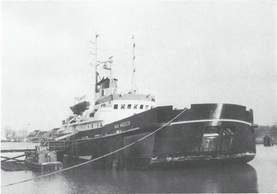
Der Stampfeisbrecher MAX WALDECK mit dem neuen Thyssen-Waas-Bug in Rendsburg, März 1982 (Foto Verfasser)
