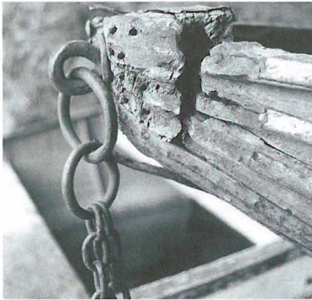
Abb. 4 Seitenansicht des Bugs. Durch die Zerstörung ist zu erkennen, wie die Planken in das Kopfbrett hineinlaufen.
