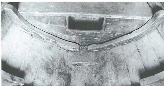
Abb. 8 Heckbank mit gegengesetzten Spanten und der Doppelung der Kielplanke.
