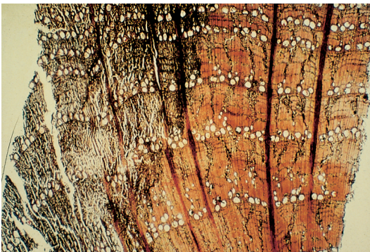
Abb. 6 Querschnitt durch eine eichene römische Schiffsplanke aus Mainz: links stark abgebautes Holz, rechts nicht abgebautes Holz. Lichtmikroskopische Aufnahme bei etwa 3- bis 4facher Vergrößerung. (Foto: P. Hoffmann/DSM)
