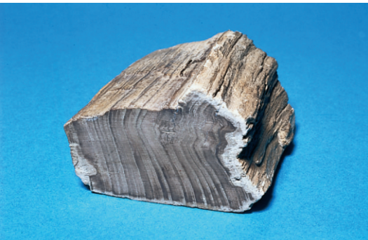
Abb. 4 In diesem versteinerten Nadelholz ist auch nach 20 Millionen Jahren das ehemals stark abgebaute Holz als hellgraue Außenschicht zu erkennen. (Foto: E. Laska/DSM)
