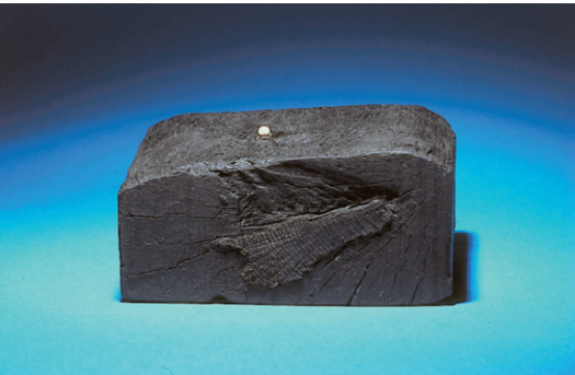
Abb. 2 Ein Stück aus der Kielplanke eines römischen Flußschiffes aus Mainz mit einem nur noch kleinen inneren Bereich kaum abgebauten Holzes. (Foto: E. Laska/DSM)
