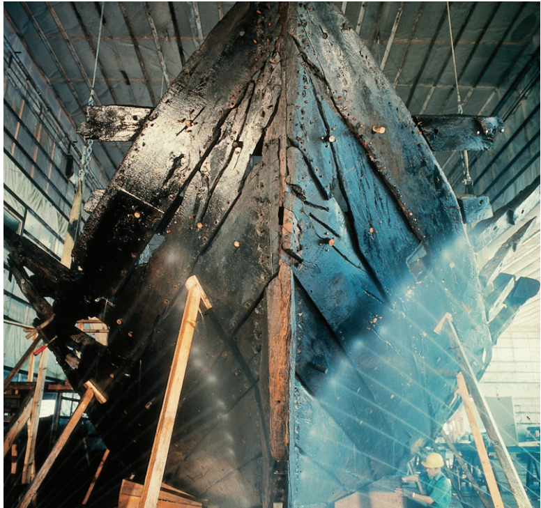
Abb. 1 Aus gut 40 Tonnen nassem archäologischem Holz rekonstruieren Schiffbauer im Deutschen Schifffahrtsmuseum die mittelalterliche Bremer Kogge. (Foto: G. Meierdierks/DSM)
