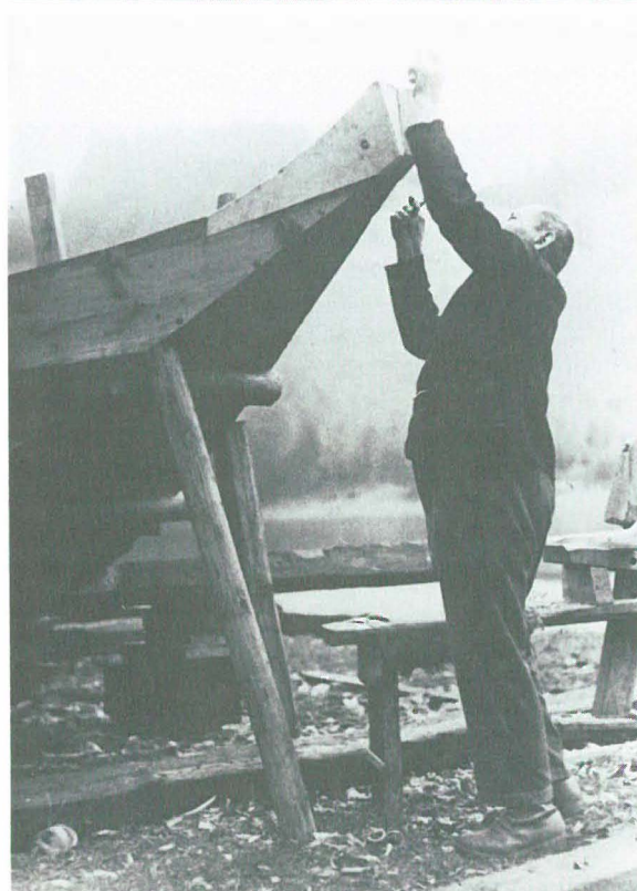
Abb. 8 Boden und Seiten werden mit der Winde zueinandergebogen.
