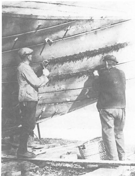
Abb. 19 Kalfaten (süddeutsch: schoppen) mit Hilfe eines hölzernen sichelförmigen Werkzeugs (rechts) und mit Kalfatholz (süddeutsch: Schöppel) und Hammer (links).
