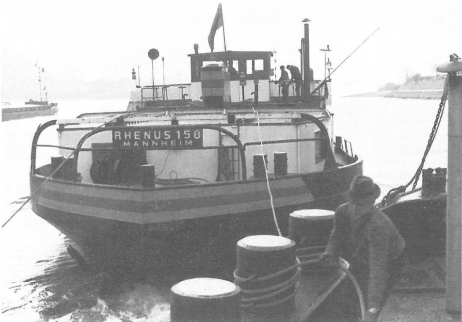
Abb. 24 »Aufpacken« eines Schleppkahns durch einen »Schleppenden Selbstfahrer«. (Foto: Verf., 1964)
