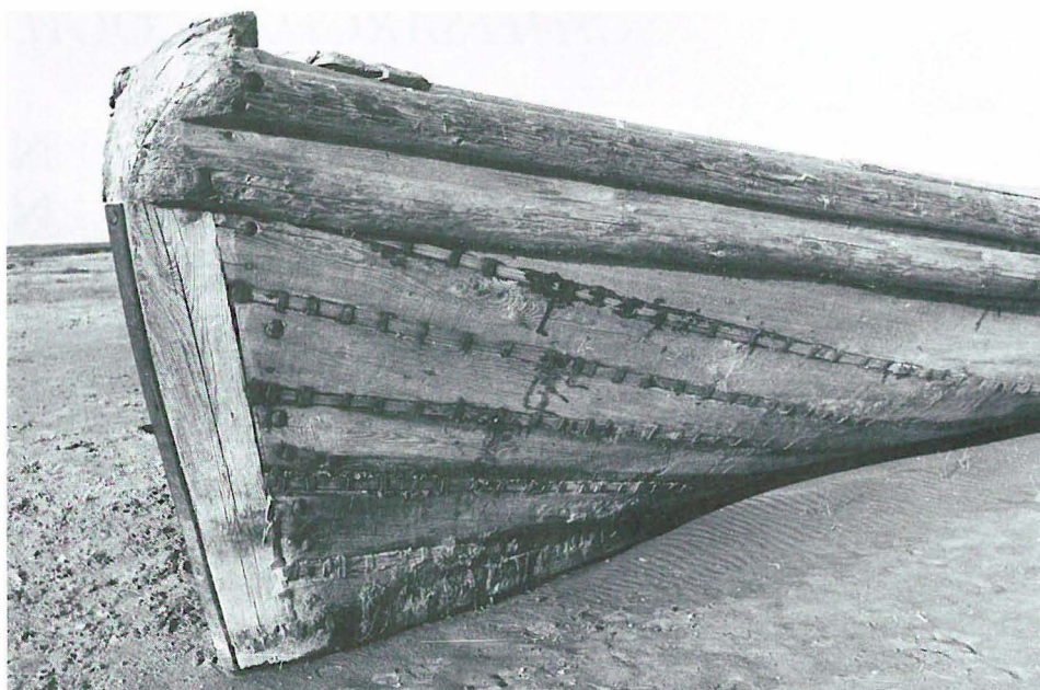
Abb. 2 Wergkalfaterung eines Soimrumpfes vom Ilmensee (2. Hälfte des 20. Jahrhunderts).
