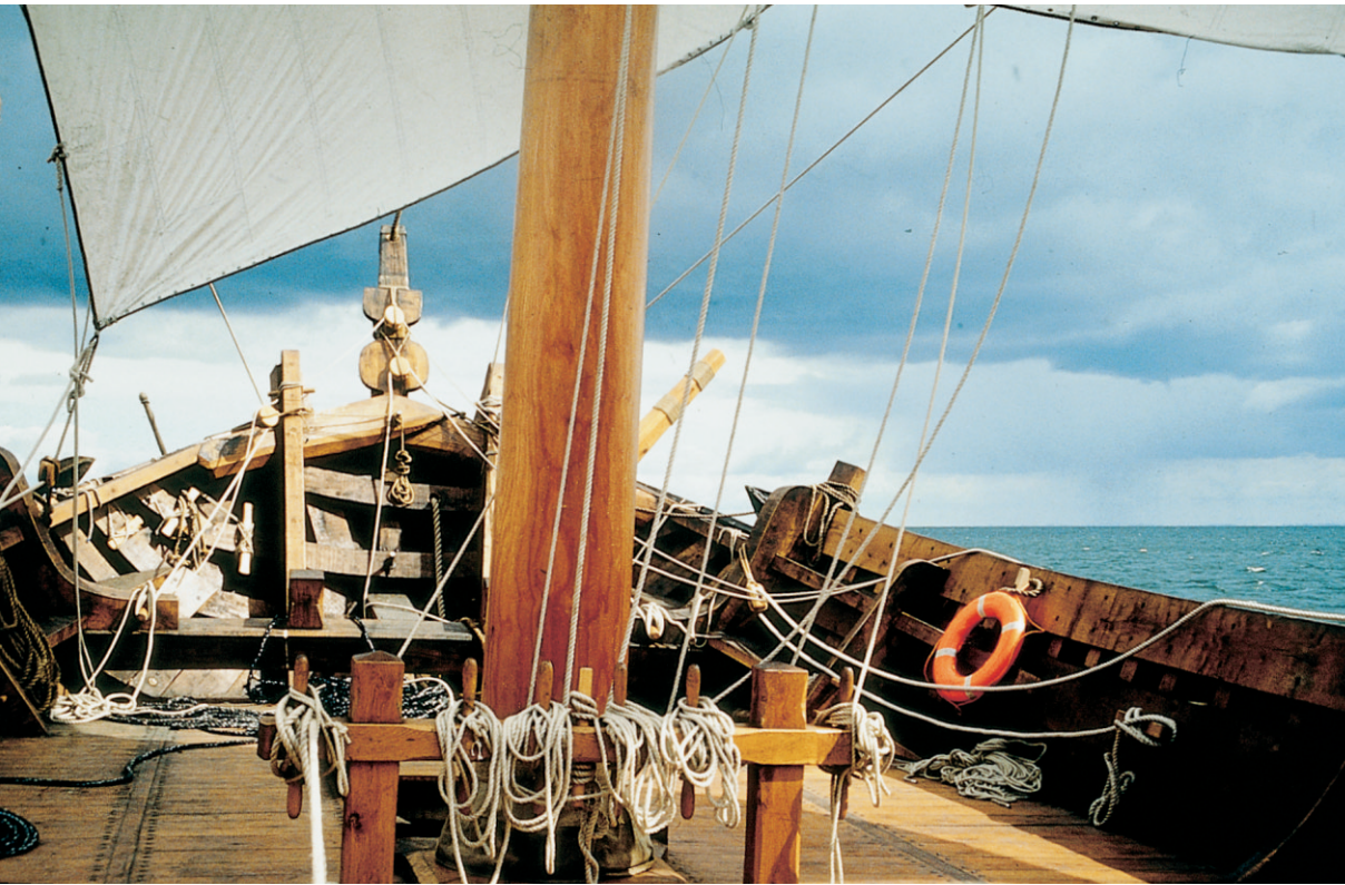
Abb. 2 Sichtfeld des Rudergängers auf dem Kieler Nachbau der Hansekogge von 1380: Die Sicht auf See und Segel ist erheblich eingeschränkt. (Foto: Archiv DSM)
