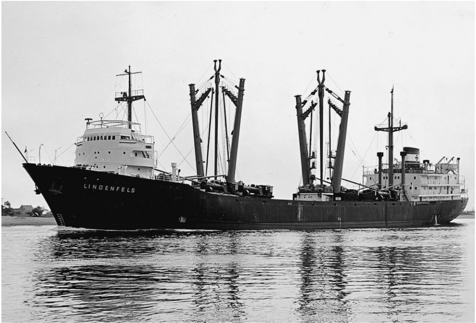
Abb. 11 Schwerguttransporter LINDENFELS von 1954 mit ausfahrbarem Steuermast. (Foto: Archiv DSM)
