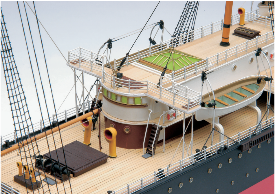
Abb. 8 Erster deutscher Schnelldampfer ELBE von 1881 (NDL): Die eingedeckte »Brücke« mit aufgesetztem Peildeck integriert die Funktionen der Schiffsführung. (Foto: E. Laska/DSM)
