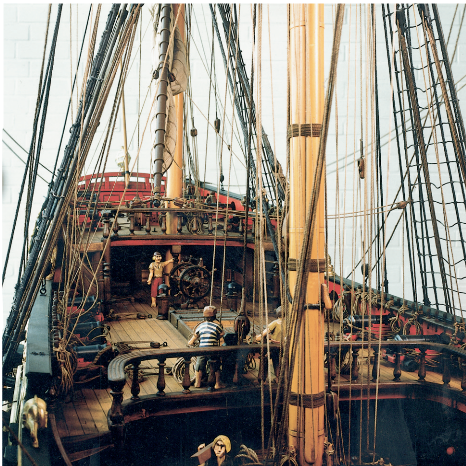
Abb. 3 Modell des nach englischer Manier gebauten Konvoischiffes WAPEN VON HAMBURG (1720 [?]): Das Steuerrad ermöglicht dem Rudergänger einen Standort an Deck. (Foto: E. Laska/DSM)
