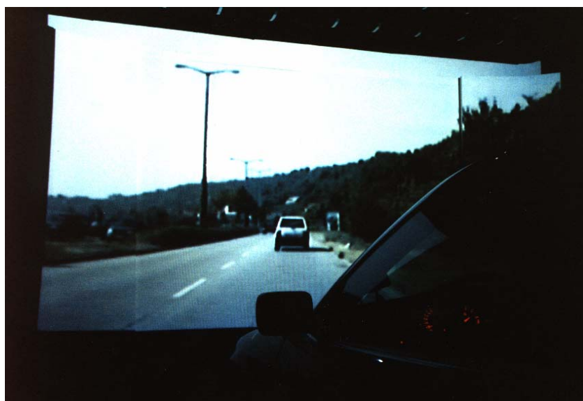
Abbildung 2: Teilansicht des Regensburger Video-Fahrsimulators
