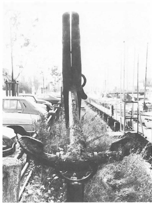
Abb. 7 Stockanker mit kontinentaler Schäftung aus der Nordsee, vor dem Morgenstern-Museum Bremerhaven (Foto Meierdierks, DSM)
